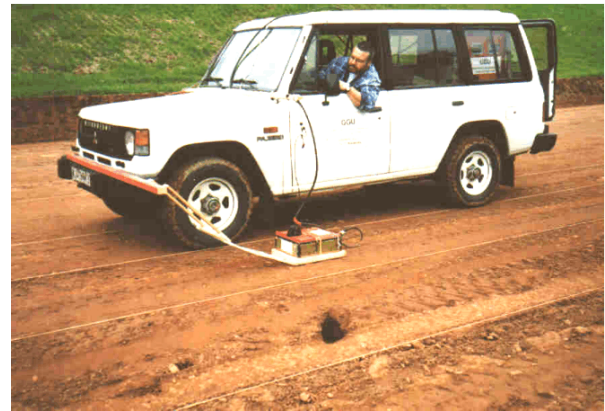
Abb. A1 Messung auf der Neubau-Trasse mit einem mittelfrequenten Radarsensor seitlich am Fahrzeug befestigt. Im Vordergrund ein offenliegender Hohlraum.
