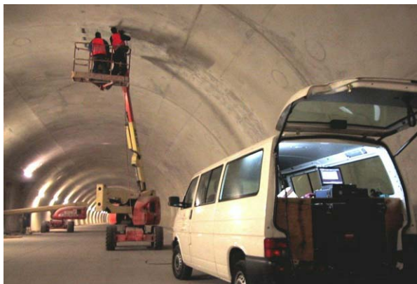
Abb. 1 Während der Meßwertaufnahme. Der Radarsensor wird von einer Hebebühne aus über die Betonfläche geführt. Die Aufzeichnungseinheit befindet sich in dem Meßfahrzeug.
