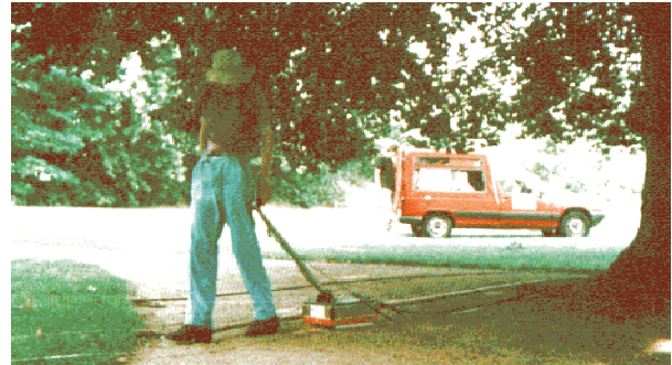
Abb. 1 Messen mit dem Georadar. Im Vordergrund der Assistent mit Radarantenne, im Hintergrund das Fahrzeug mit der Meßapparatur.
