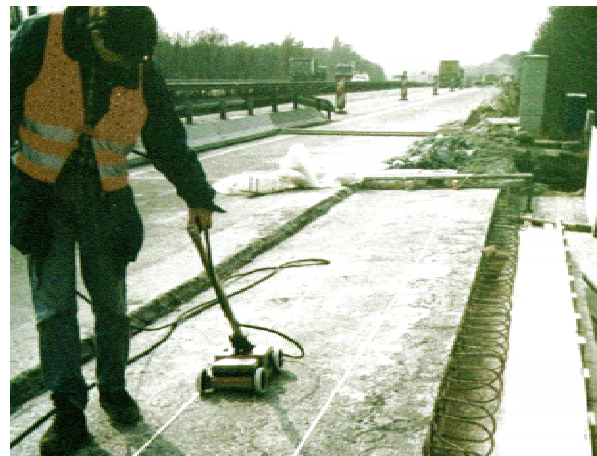
Abb. 1 Meßwertaufnahme mittels Radarantenne
